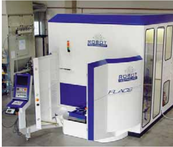
Laser-Schneidezellen von Robot-Technology: Auch hier wird auf das Design geachtet und mit Freiformflächen gearbeitet.
